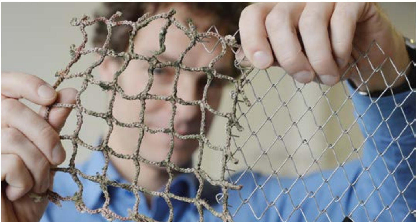
Stahl ersetzt Nylon: Das Fishfarming-Projekt ebnete der Romanshorn Geobrigg AG den Weg in neue Märkte.
